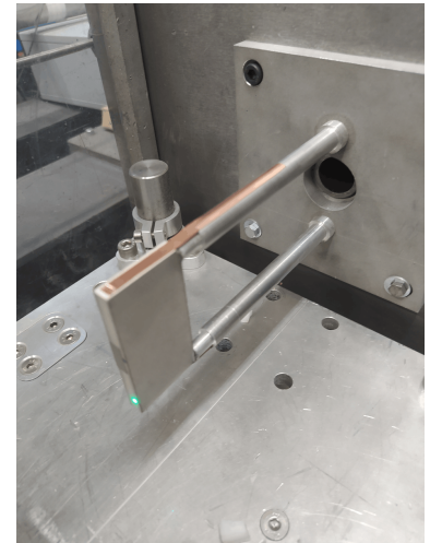
(b) Vue du dessus du montage expérimental des essais d'impact sur tranche (inspiration de Dargaud, 2021). (c) Photographie du montage expérimental.
