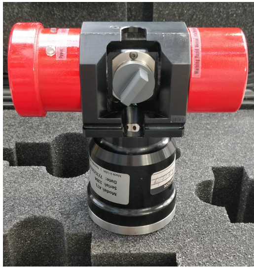
FIGURE 1.6 – Tête active, asservie pour conserver le faisceau du laser tracker dans le cône de réflexion
