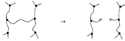
Figure 2-10. Schéma de la destruction d'une chaîne élastiquement active (CEA) dans le cas d'un réseau trifonctionnel.
