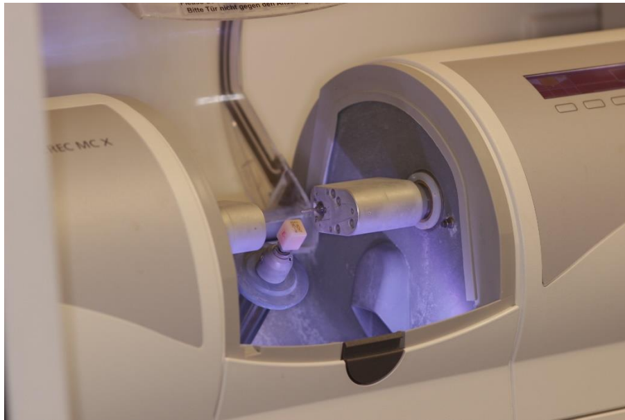
Figure 1-5. Usineuse pour blocs destinés à des restaurations dentaires
