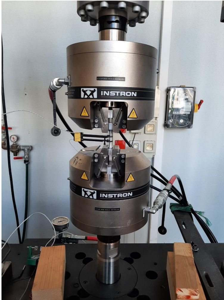
Figure 95 Montage d'essai en traction monotone pour éprouvette cylindrique
