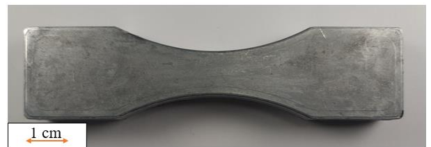
Figure 66 Photographie d'une éprouvette brute coulée sous pression
