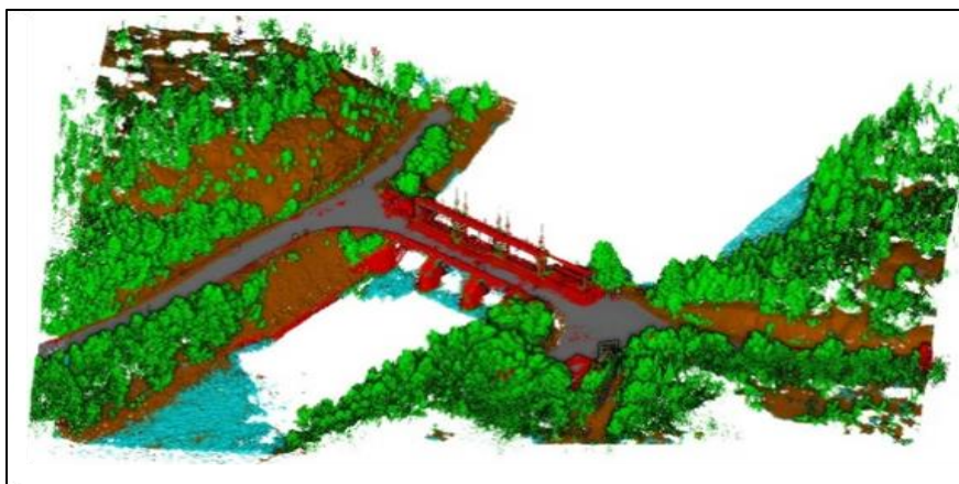
Figure 4.20 Localisation #1 après segmentation sémantique multisource
