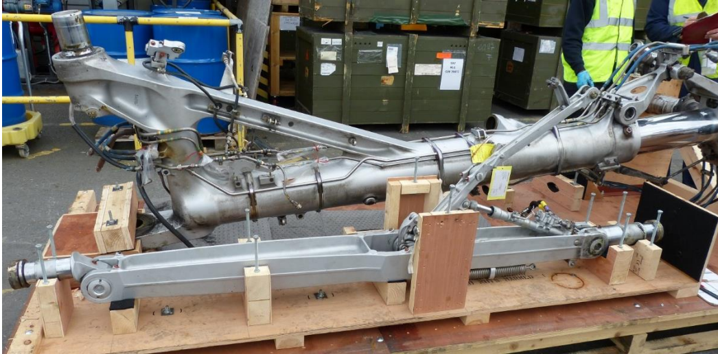
Figure 28 : Train d'atterrissage à l'arrivée au centre de maintenance (MRO)
