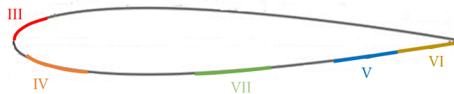
FIGURE 2.24 – Différentes positions des bandes de rugosité testées sur l'hydrofoil
