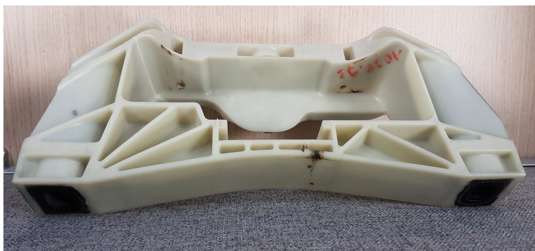
Figure 4.16 – Vue avant d'un étrier après l'essai de fatigue avec une fissure apparaît au coin en haut à gauche de la pièce.
