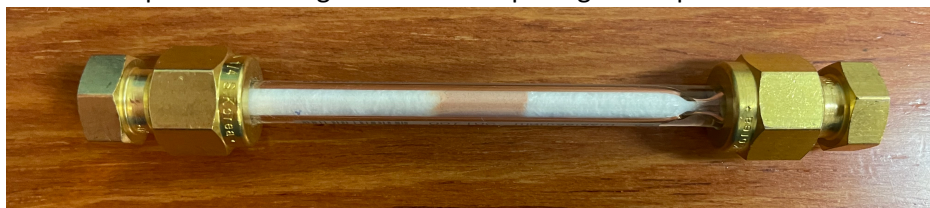
Figure 75 : Tube de TD rempli avec 15mg de MOFs et 100mg de laine silanisée
