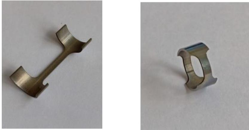
**Figure 31** Eprouvettes de traction Tuile (à gauche) et Anneau (à droite)
