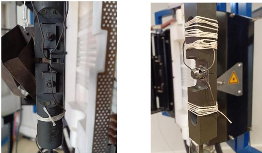
**Figure 32** Montages de l'essai de traction sur Tuiles à gauche et sur Anneaux à droite avec thermocouples en place
