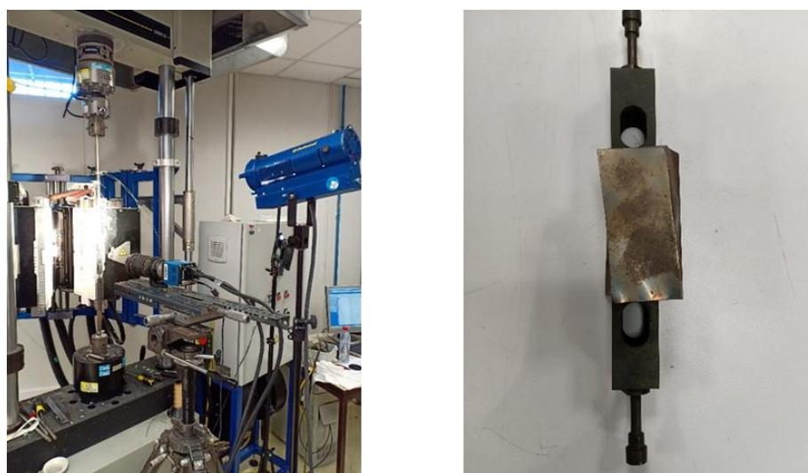
**Figure 33** La Caméra scientifique pco.edge 5.5 et le four à lampes à gauche, la feuille métallique en place à droite
