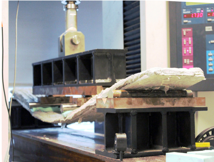
FIGURE 3.5 – Photographie de la plaque fléchie durant l'essai.
