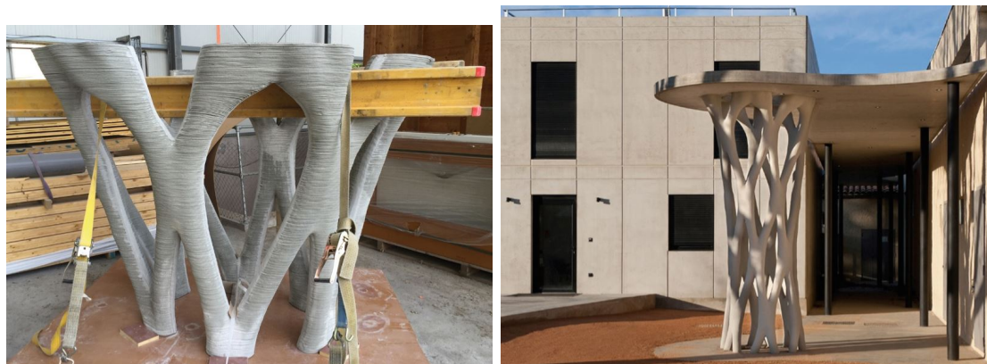
FIGURE 1.18 – Coulage de béton fibré dans un moule imprimé en 3D [48].
