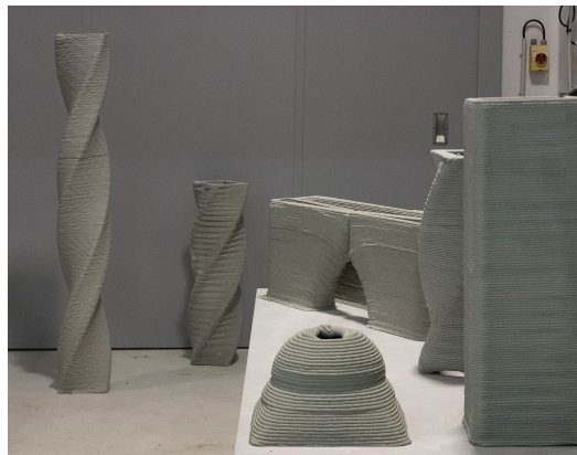
FIGURE 1.1 – Exemples d’objets réalisés en impression 3D béton par extrusion au Build’In Lab de l’Ecole des Ponts ParisTech, dont un dôme et une arche imprimées sans support [10].
