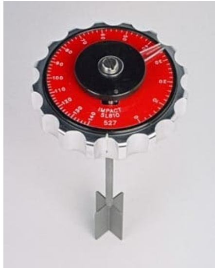
FIGURE 4.24 – Photographie d'un scissomètre classique (Source : mtlabs.co.nz)
