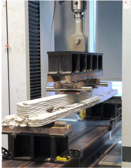
FIGURE 3.8 – Photographie de la poutre montée sur le banc d'essai de flexion.
