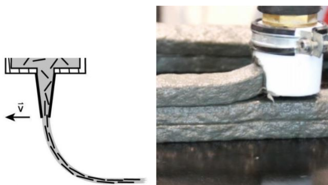
FIGURE 1.19 – Schéma de principe de l'extrusion d'un matériau renforcé avec des fibres courtes, mettant en évidence l'orientation préférentielle des fibres et photographie d'une impression d'un matériau fibré. [15]
