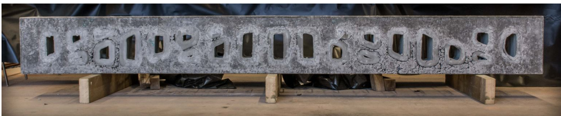
FIGURE 1.11 – Prototype de poutre de 3m de long à coffrages imprimés en béton [38].
