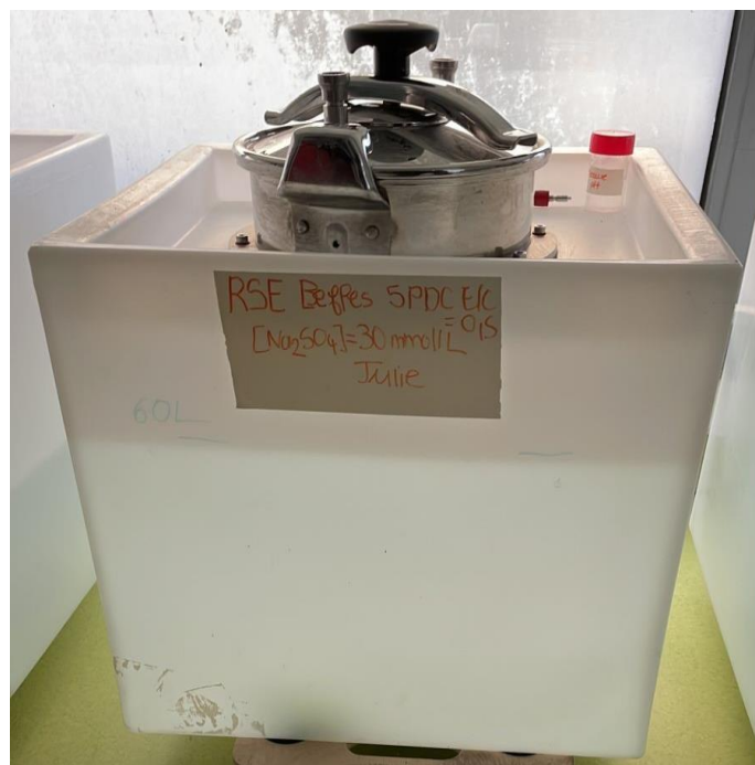
Figure 2-9 : Essais à volume infini : bac étanche contenant 60 L d'une solution de \text{Na}_2\text{SO}_4 de concentration 30 mmol/L. Le couvercle a été conçu de manière à injecter de l'azote à l'intérieur afin d'éviter la carbonatation des échantillons.
