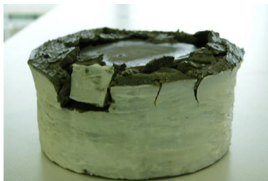
Figure 1-13 : Dégradation d'une pâte de ciment de rapport E/C de 0,6 après 3 mois de dégradation en milieu sulfaté (Ragoug et al., 2019).
