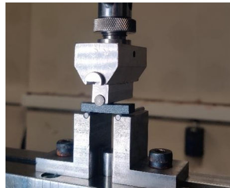
Figure II-13 Schéma du montage de flexion 3 points rapprochés (gauche) et image du montage avec barreau de PEKK/FC (droite)
