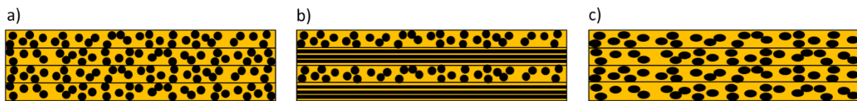
Figure IV-20 Vue en coupe partielle d'un échantillon de composite a) unidirectionnel, b) empilé à 0/90, c) empilé à \pm 45^\circ
