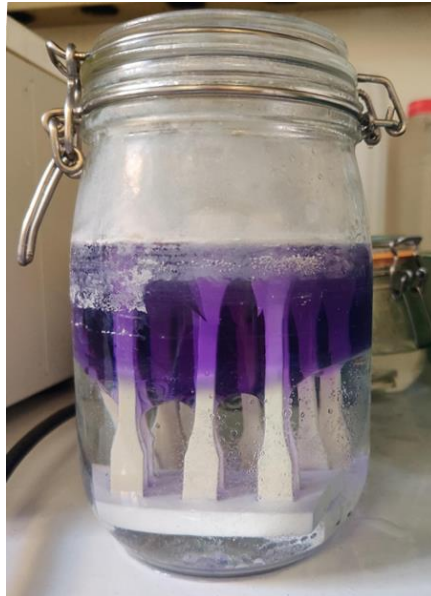
Figure II-5 Montage des éprouvettes de traction dans le mélange Skydrol/eau (photo prise à 50°C)
