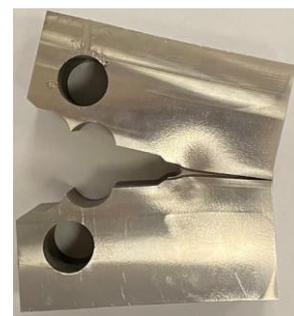
Figure C-3 Éléments écrasés par le contact des entailles latérales en face arrière
