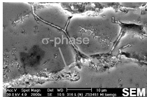
(b) Phase de sigma après un vieillissement à 600°C pendant 85000 h
