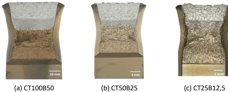
Figure 5-20 Faciès de rupture de CT homothétiques à l'état neuf (M1)
