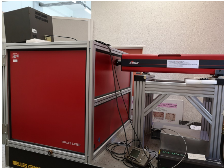
Figure 12 : Installation de choc laser Thales SAGA 330 avec la tête laser en haut à droite et l'enceinte d'expérimentation à gauche
