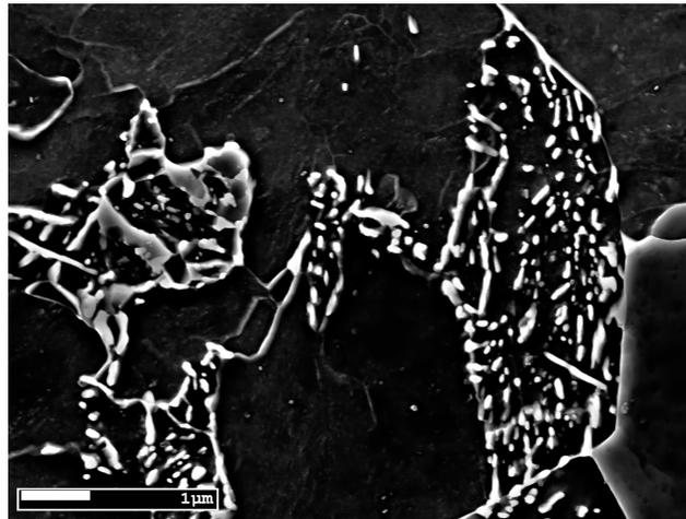
**FIGURE 3.12** – Détail d'un amas de carbures. Traitement thermique  $2000^{\circ}\text{C} \cdot \text{h}^{-1} -640^{\circ}\text{C} -1 \text{ h}$ . Image MEB en mode électrons secondaires.
