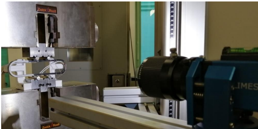
Figure 72 : Vue globale de l'essai de flexion 4 points. Sur la gauche : le montage de flexion 4 points. Un échantillon est positionné sur le montage. Sur la droite : la caméra utilisée pour les mesures de champs.
