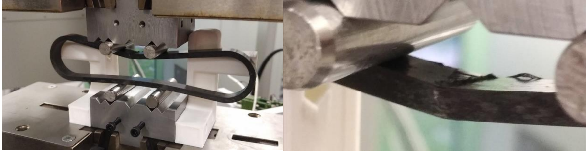
Figure annexe 5 : Bielle n°157 après un essai de flexion 4 points jusqu'à rupture.
