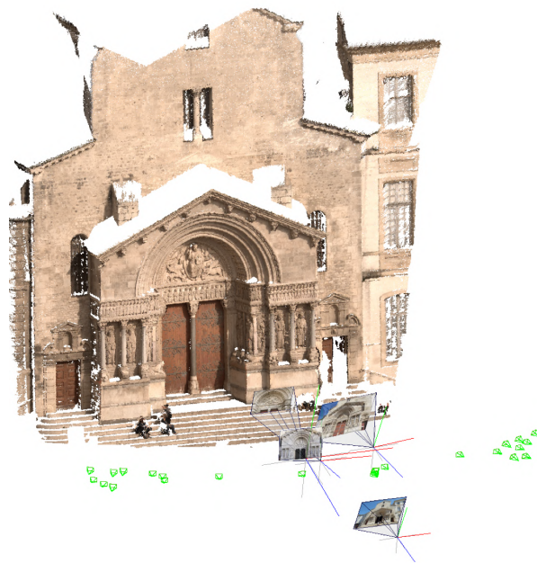
FIGURE IV.17 – Recalage par résection spatiale d’images d’archives trouvées en ligne sur le jeu de données Saint-Trophime .
