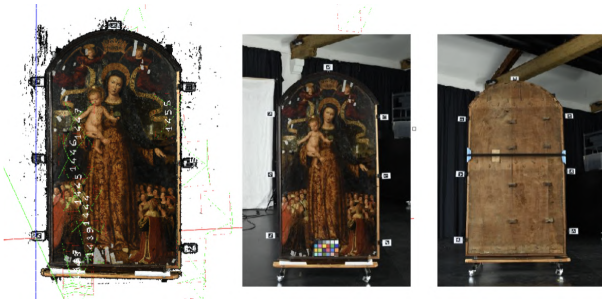
FIGURE IV.12 – Expérimentation de cibles codées en double-face pour permettre le recalage automatisé des blocs photogrammétriques recto et verso d'un retable.
