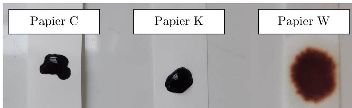
**Figure 2.4.** Test au Lugol permettant de révéler la présence d'amidon dans les papiers Canson (C) et Klug (K) et l'absence d'amidon dans le papier Whatman (W).
