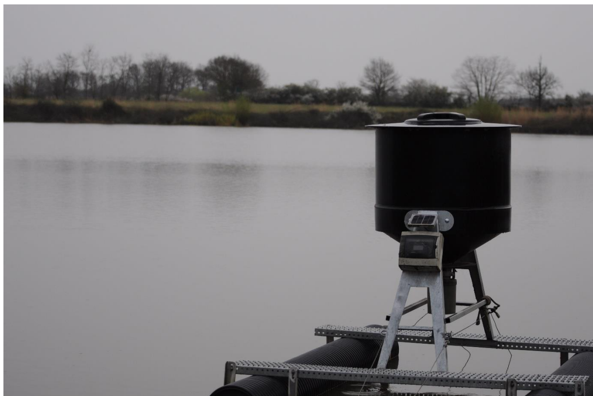
Figure 11 : Système flottant et autonome (alimentation photovoltaïque) pour la distribution d'aliments en étang.
