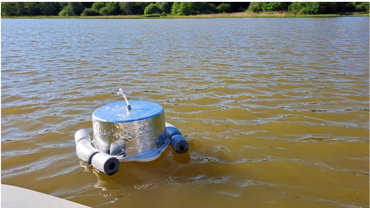
Figure 20 : Dispositif de chambre flottante utilisé sur les étangs pour capter les bulles de méthane remontant depuis les sédiments (ébullition).
