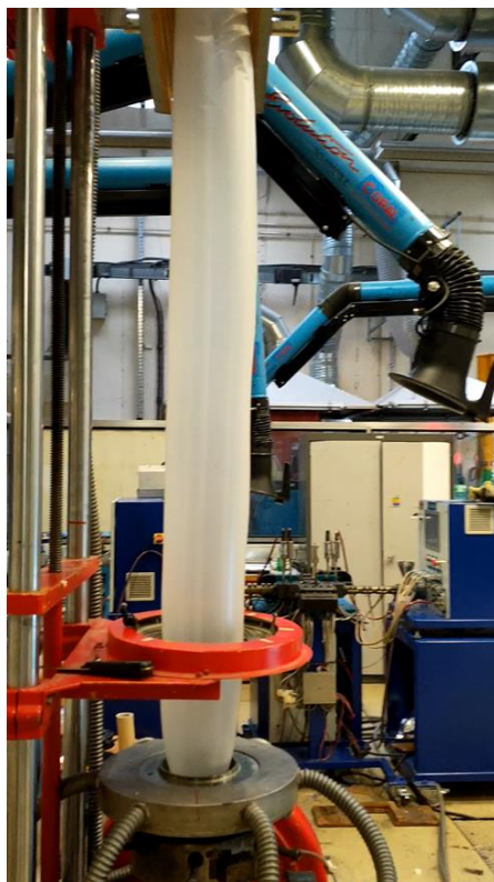
Figure VII.9: Extrusion-soufflage de gaine de la formulation plastifiée PHBV/PBSA/ATBC 63/27/10+ 0.2 phr Luperox® avec un Blow Up Ratio de 3.8, la taille de la bulle est d'environ 180 cm
