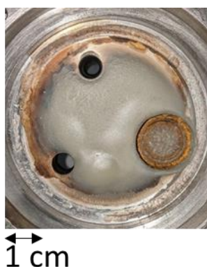
Figure 68 : Vue du dessous de la tête en acier, refroidie à 12°C, après réaction entre le sel fondu eutectique ternaire carbonates (LiNaK(CO 3 )) et le PE à 450°C, sous P(Ar)=1bar
