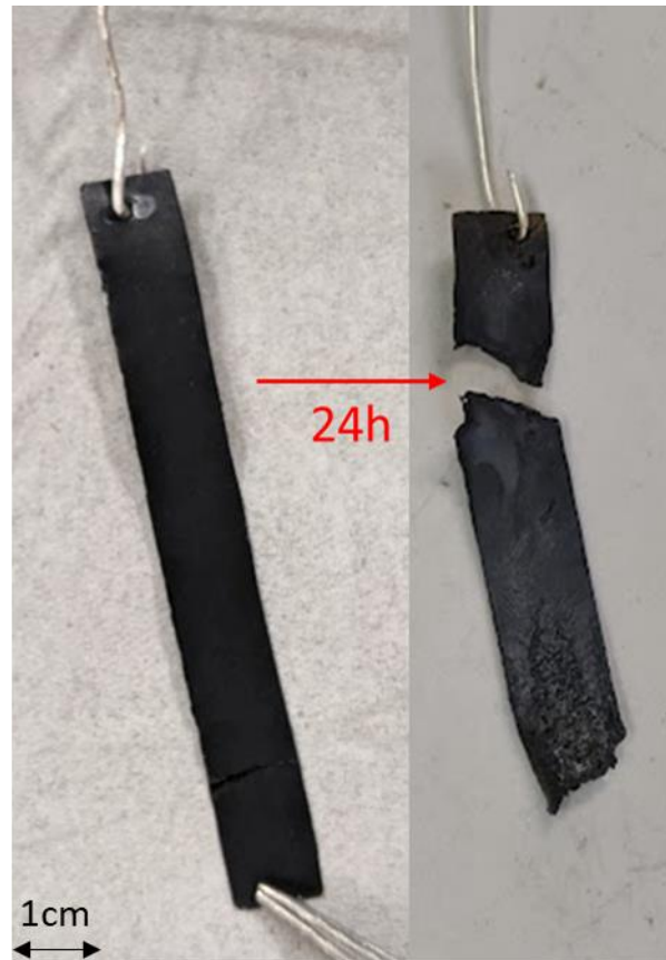
Figure 52 : Bande de cathode LCO avant et après 24h de réaction avec un bain eutectique hydroxydes ( \text{NaK}(\text{OH}) ) à 300^\circ\text{C} sous P(\text{Ar})=1\text{bar} humidifié
