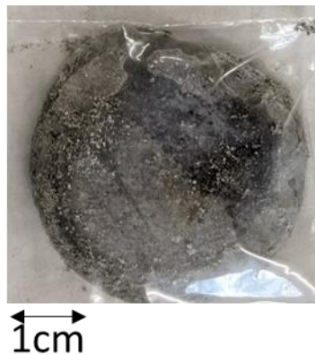
Figure 50 : Photo du galet refroidi d'eutectique (NaK(OH)) et de la poudre LCO après 5 jours à 300°C sous P(Ar)=1bar humidifié, vue du dessous
