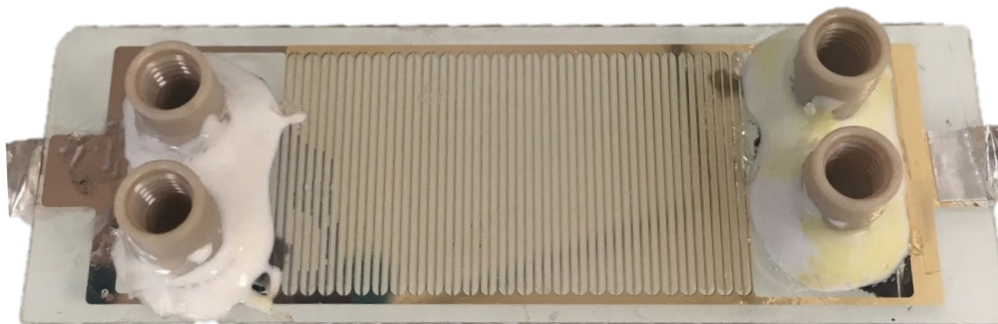
Figure 22 : Biflow 2.7 après que le benzofurane ait contaminé la résine (à droite la résine est jaune au lieu d'être blanche)
