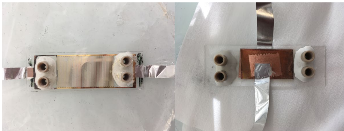
Figure 21 : Biflow 2.7 avec des NanoPorts™ et présentation de deux types d'électrodes (à gauche forme en peigne avec chrome et or, à droite avec du scotch de cuivre)
