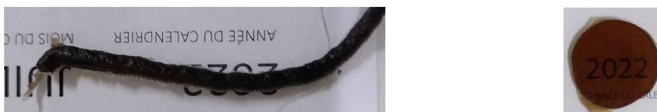
Figure 4.13. Extrudat (gauche) et échantillon de rhéologie du réseau P(S-co-HOS_{0,1}-Na_{0,1})-(T-OPh^{Et}_3)_{0,1}-E après moulage par compression à 180 ^{\circ}C (droite).
