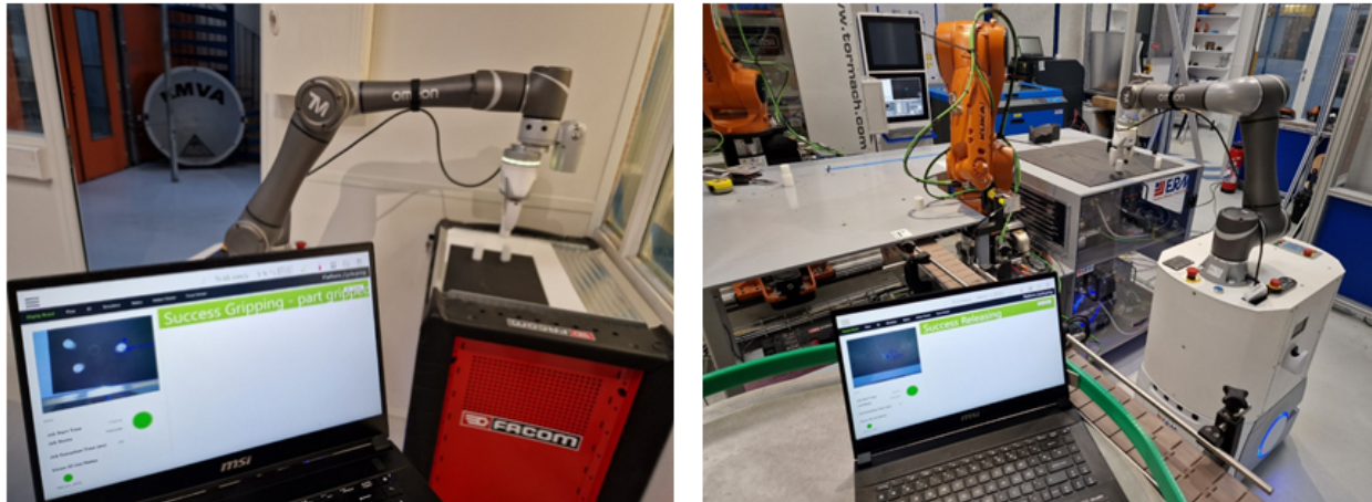
FIGURE B.43 – Opération de cueillette guidée par vision de pièces brutes (gauche) et opération de placement guidée par vision de pièces brutes (droite)
