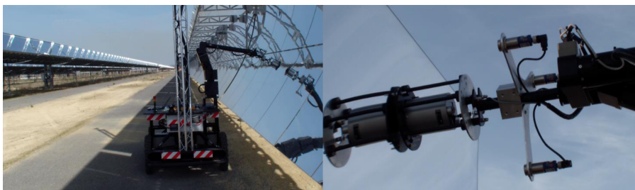
FIGURE B.23 – Mesure de la réflectivité du miroir dans la centrale énergétique de VALLE par MAINBOT adoptée de [64]
