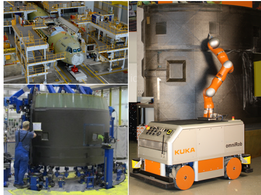
FIGURE B.24 – Utilisation du MM dans le système de production aérospatiale d'Airbus Defence Space adoptée de [68]
