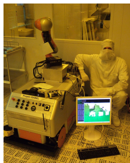
FIGURE B.22 – Implémentation du MM ISABEL pour la prise et la pose de boîtes de plaquettes dans une salle blanche adoptée de [63]
