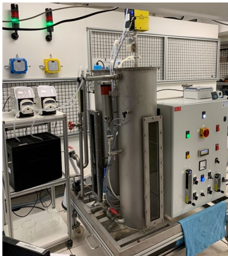
Figure II. 6 : Montage du pilote d'ozonation avec la glacière utilisée (à gauche en noir) pour l'ajout des réactifs.
