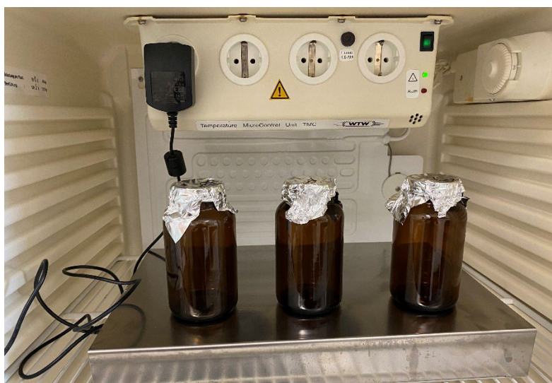
Figure II. 2 : Réacteur utilisé pour les oxydations en batch à l'échelle laboratoire.
