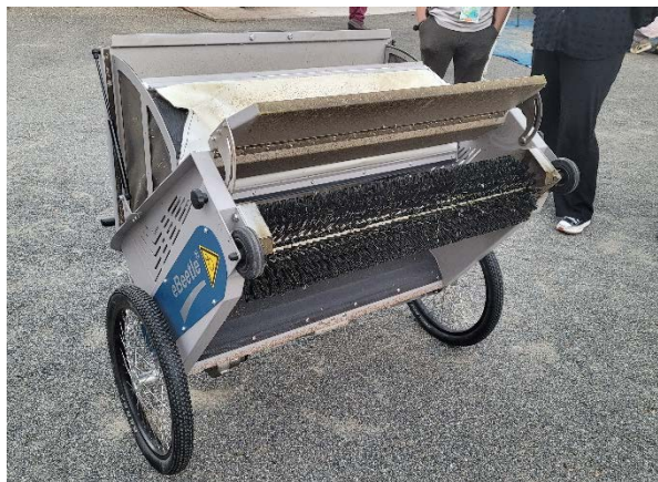
Brosseuse « butineuse » à traction électrique pour la collecte de semences en milieux isolés ou accidentés
