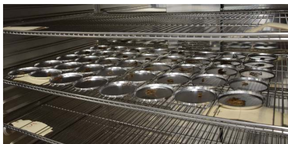
Etuvage après lavage et pesée des racines fraîches
