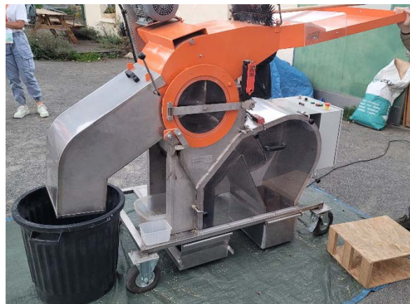
Emondeuse pour séparer la matière inerte des produits de collecte
