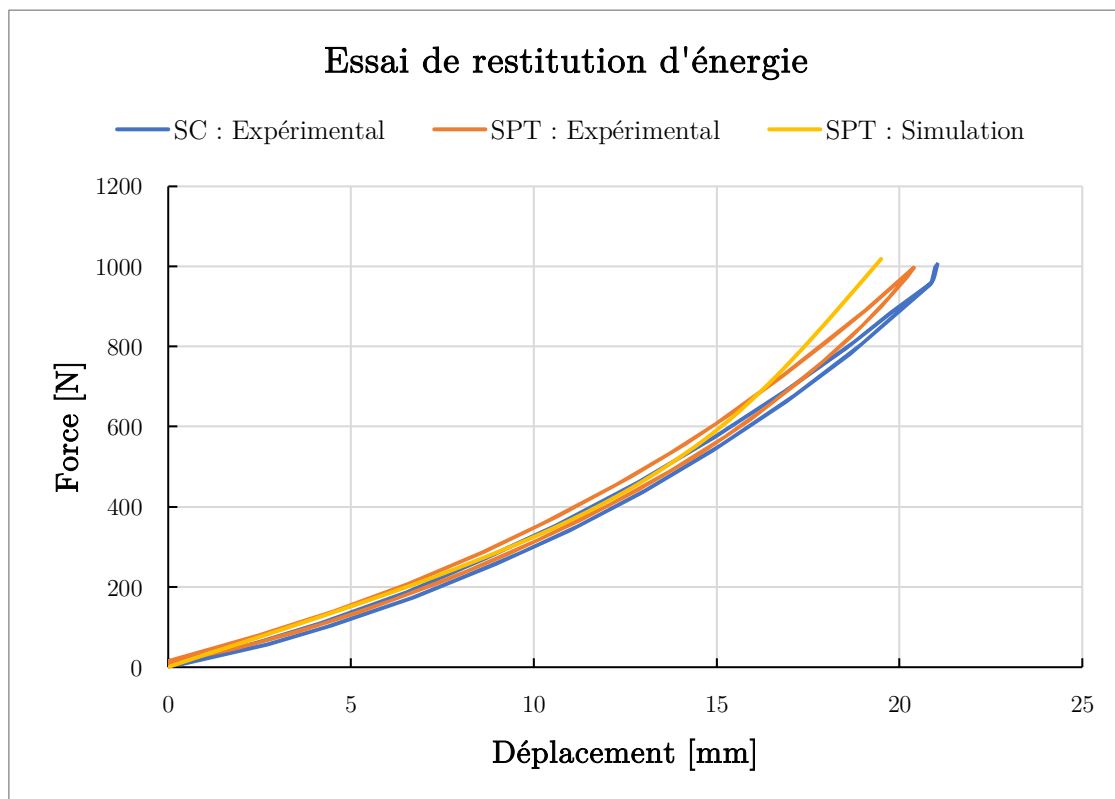
Figure 118 : Courbe force-déplacement d'un essai de restitution d'énergie de l'avant pied sous 1000 N. Résultats expérimentaux pour le pied SC (bleu) et SPT (orange). Les résultats provenant de la simulation par EF pour le pied SPT sont présentés en jaune.
