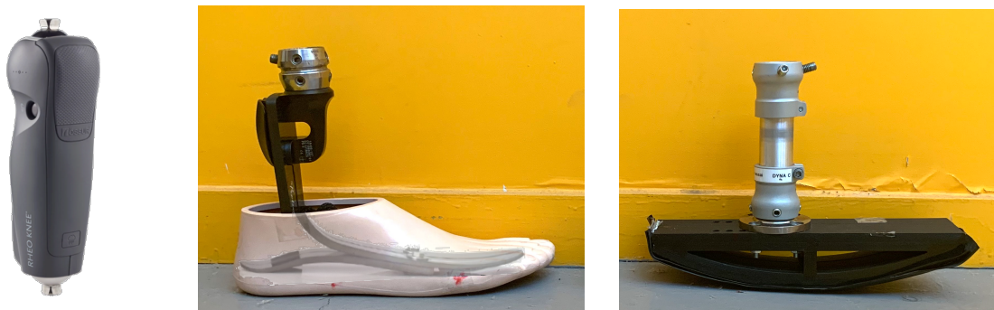
Figure 59 : Prothèses utilisées pendant la marche. A gauche, le Rheo Knee™ d'Össur®. Au centre, l'ESAR Dynatreck™ de Proteor®. A droite, le pied rigide courbé en demi-cercle, imprimé en 3D et ayant la même masse que le pied ESAR.
