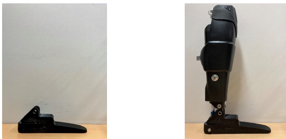
Figure 96 : Installation du prototype sur la prothèse Synsys.
