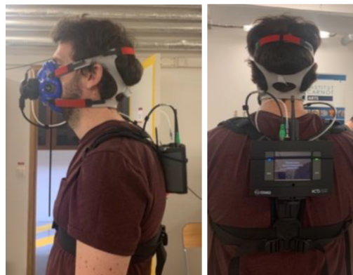
Figure 62 : Un participant équipé du système de spirométrie K5™ de Cosmed®.
