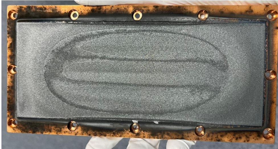
Figure 43. Cible pulvérisée. La zone creusée correspond à la zone où se ferment les lignes de champ magnétique.
