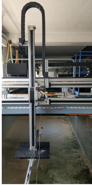
FIGURE 1.8 – Chariot et bras motorisé du canal 1 permettant de positionner les nageurs.
