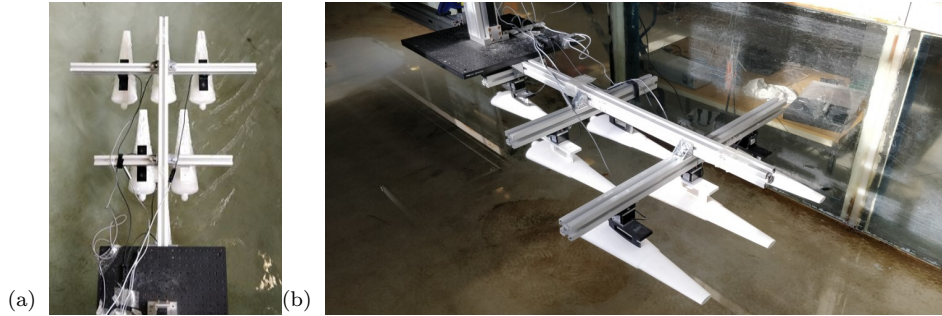
FIGURE 3.3 – Peloton en « flèche » dans le canal à courant. (a) Vue en eau (le modèle de tête est caché par la plaque noire). (b) Vue hors de l'eau.
