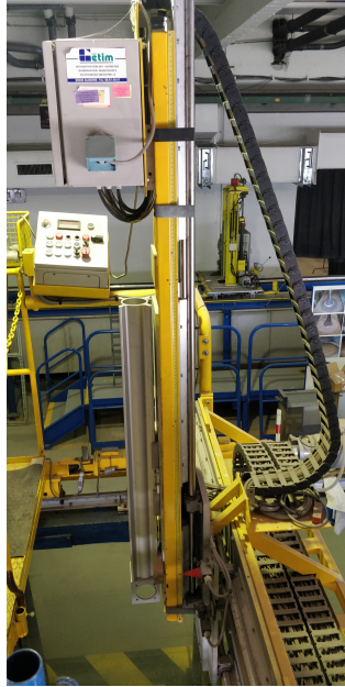
FIGURE 1.4 – Chariot et bras motorisé du canal 5 permettant de positionner les nageurs.
