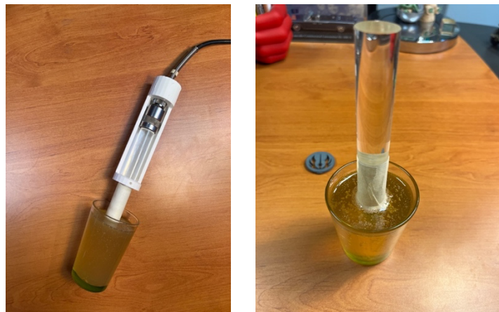
Photo 6 : sonde de prismétrie. Dispositif expérimental pour mesurer l'évolution des ondes US
