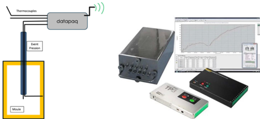
Figure 9: dispositif de mesure de température datapaq™
