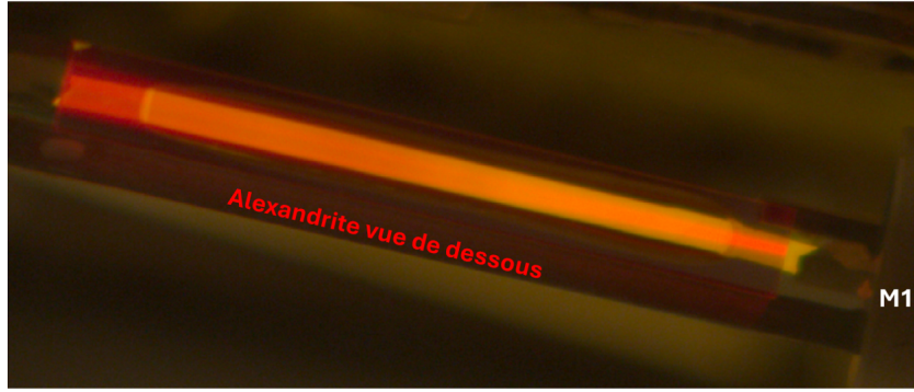
FIGURE 3.21 – Photo du cristal d'alexandrite vu de dessous. Les multiples passages forment un éventail dans le cristal, centrée dans la zone de gain c'est à dire sous le concentrateur luminescent. La zone du concentrateur luminescent correspond au rectangle de couleur jaune orangé par transparence de l'alexandrite.
