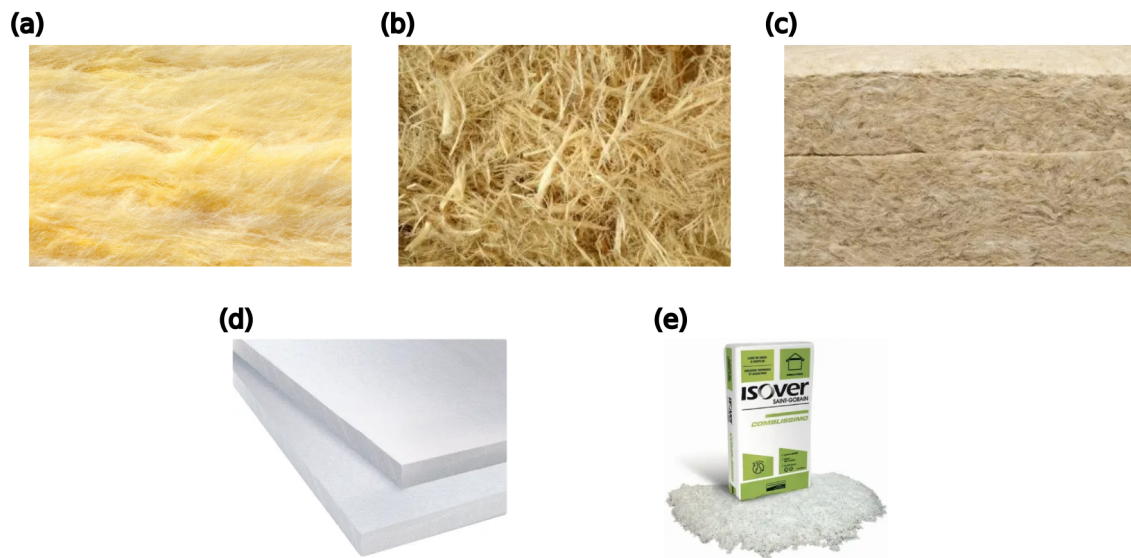
FIGURE 1.1 – Quelques produits d’isolation standards : (a) Laine de verre, (b) Panneau de fibres de bois, (c) Laine de roche, (d) Panneau de polystyrène expansé, et (e) Laine à souffler. Source : www.isover.fr .
