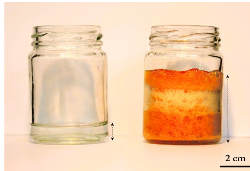
FIGURE 1.22 – Illustration de l'apparition d'une porosité induite par la polymérisation sur un échantillon de résine polyester diluée dans l'eau : à gauche, solution avant polymérisation ; à droite, liant après polymérisation. Une formation de mousse est observée en raison du dégagement d'espèces gazeuses pendant la réaction [60].
